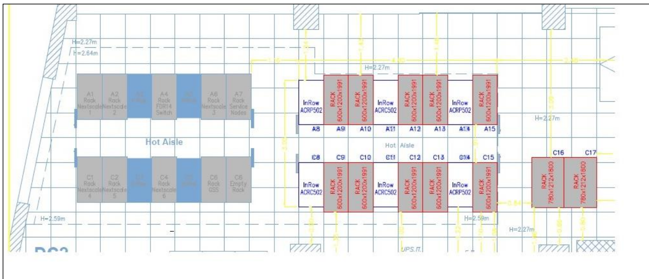
Εικόνα 8 Κάτοψη Υφιστάμενων Ικριωμάτων
